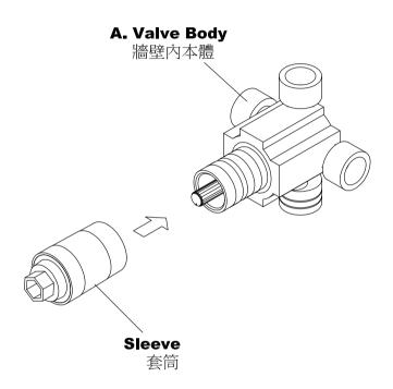
\* Use **Sleeve** to protect the cartridge and thread before installation. 使用套筒保護陶瓷中心栓及螺牙,必須在安裝程序前先套上。
