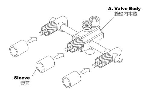
\* Use **Sleeves** to protect the cartridge and thread before installation. 使用套筒保護陶瓷中心栓及螺牙,必須在安裝程序前先套上。
